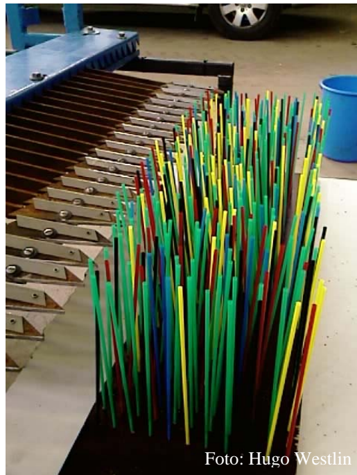
Figur 10. Den försöksupställning som användes för att med hjälp av sugrör testa olika inställningar på vegetationsskäraren. Totalt 341 sugrör monterades fast i plywoodskivan.
